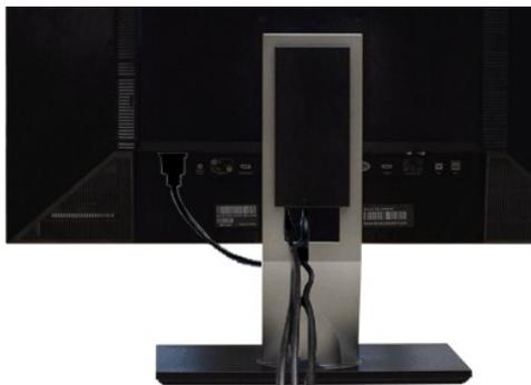
Nachdem Sie alle erforderlichen Kabel an den Monitor und Computer angeschlossen haben (Näheres zum Kabelanschluss unter [Einrichten Ihres Monitors](#)), sollten Sie den Kabelhalter zur übersichtlichen Anordnung aller Kabel, wie oben stehend gezeigt, verwenden.
