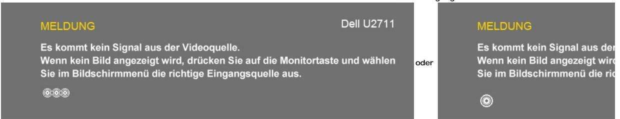
Wenn entweder VGA-, DVI-D-, HDMI- oder DisplayPort-Eingang ausgewählt ist und VGA-, DVI-D-, HDMI- und DisplayPort-Kabel nicht angeschlossen sind, erscheint Dialogfeld, wie in der folgenden Abbildung zu sehen ist.
