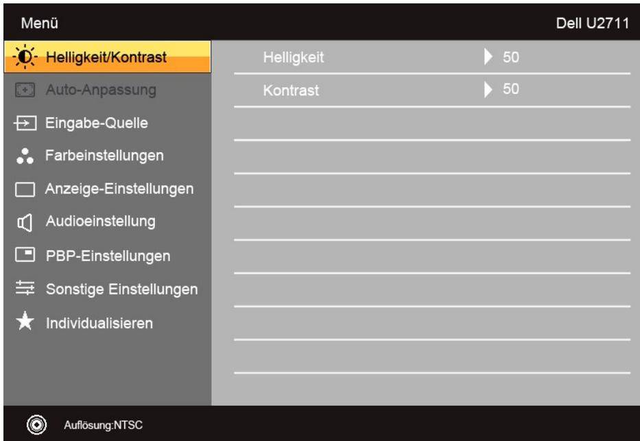
**HINWEIS:** Das Auto-Setup steht nur zur Verfügung, wenn Sie den analogen (VGA) Anschluss verwenden.
