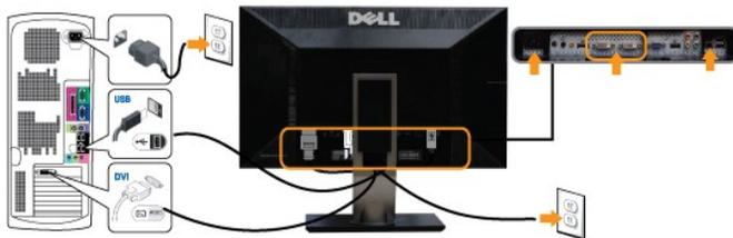
**HINWEIS:** Ihr Monitor unterstützt zwei DVI-Anschlüsse. Sie können die Eingangsquelle (DVI-D 1 oder DVI-D 2) über die Eingangsquellenauswahl-Option im OSD-Menü auswählen.
