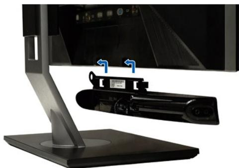
1. Von der Monitorrückseite aus befestigen Sie die Soundbar, indem Sie zunächst die beiden Schlitze mit den Zapfen an der unteren Monitorrückseite ausrichten.
